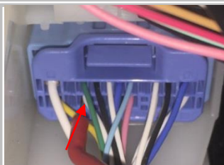
3.34 接 CAN 线：蓝色连接器第 二排从左向右数第三号孔位的白 色线接我司的绿黑色线
