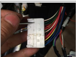
3.15 布正极线：撬起白色线盒中间的小横条，目的是方便安装正极端口时卡紧到位；
