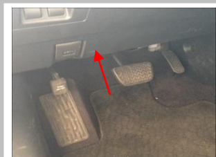
3.24 解码器线束：原车方向盘中控台处拆下（箭头）
