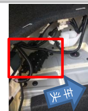
1.6 驱动盒按图示包裹减振棉后粘贴放置在尾箱左侧内饰板角落空隙内。
