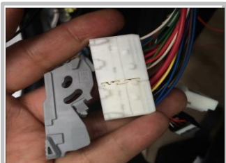
3.13 布正极线：灰色塑胶件已拆下
