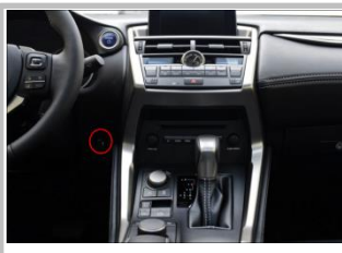
3.27 NX 中控开关位置，原车空 位键，取下来原车空位键，
