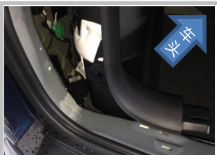
1.7 驱动盒以及拉线布置完成，如图所示，注意：内饰板等布置好驱动盒线束后再还原。
