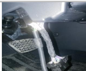
3.26 对插转接插头后复原原车 OBD 处（原车方向盘下）；
