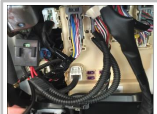
3.19 撑杆负极接在尾门盖板上门锁此处位置；
