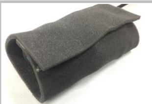
1.5 门锁驱动盒，使用减振棉包裹并粘牢，防止共振，并减少噪音。背面有用于固定在车身的不干胶。
