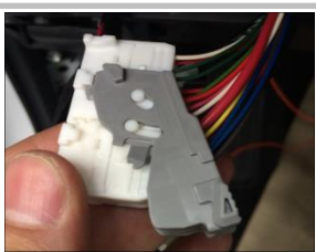
3.14 布正极线：推一下箭头此处的卡位，然后把灰色塑胶件拆下，
