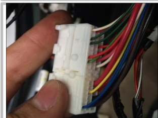
3.16 布正极线：中间小横条凸起即可；目的是方便安装正极端口时卡紧到位
