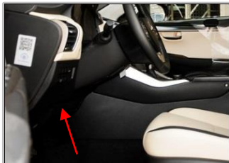
3.29 接正极线：在驾驶室附近的 方向盘中控台位置把装饰塑料盖 拆下；（箭头）
