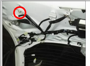
3.21 负极：用我司负极连接此原车螺栓柱，螺母还原拧紧；
