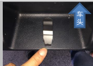
1.9 对干涉部分割胶，需割胶 4~5mm，朝车尾方向，如图，然后再安装割胶后的后踏盖。
